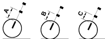
S2.1 - Durchhang Messungen Vorderseite
