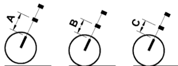
S2.1 - Durchhang Messungen Vorderseite
