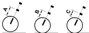
S2.1 - Durchhang Messungen Vorderseite
